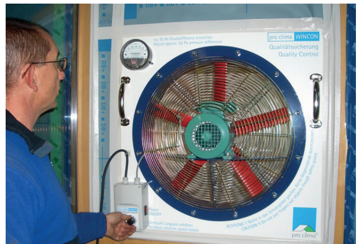
16. Kvalitetssikring Det anbefales at afprøve tætheden vha. en WINCON- eller BlowerDoor-test.
